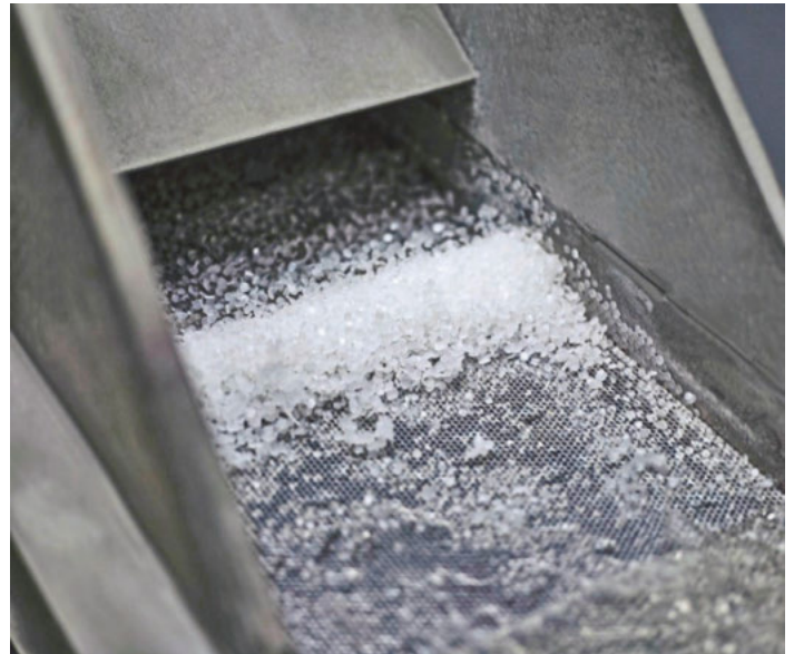
Durch mechanisches Recycling wird aus Kunststofffolien Granulat gewonnen. Da sich die Qualität des Materials infolge des Recyclings jedoch reduziert, stößt die stoffliche Wiederverwertung an ihre Grenzen.
